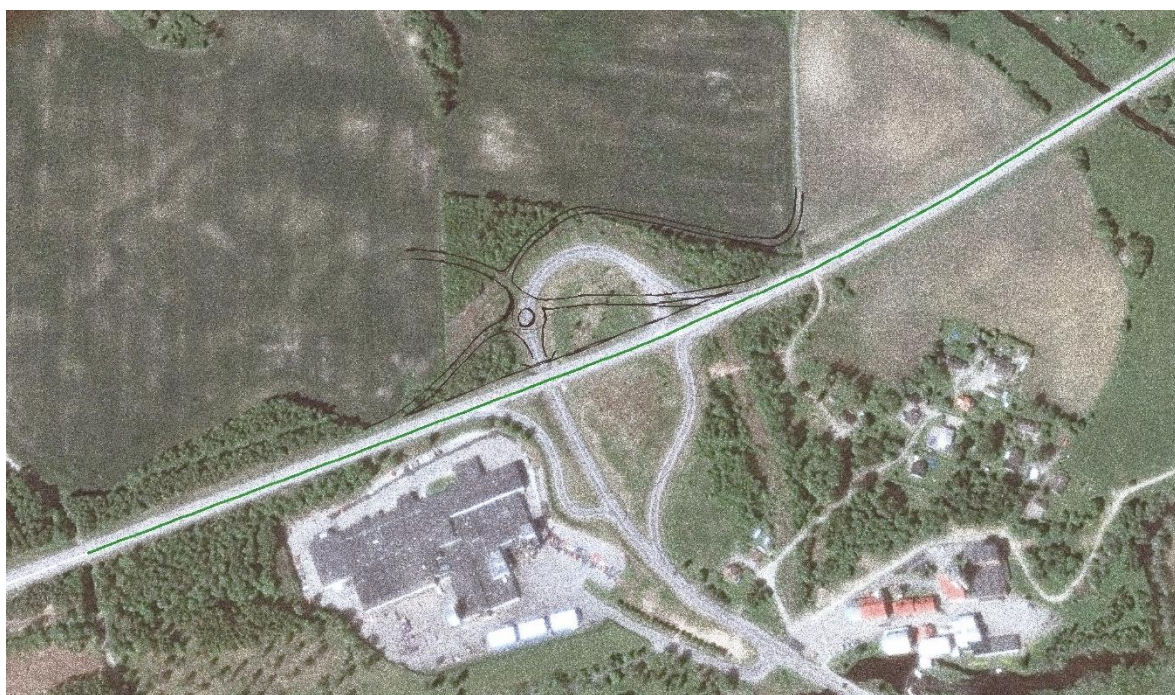
Figur 36 - Illustration av förkastad ruterutformning för trafikplats Hjultorp.
