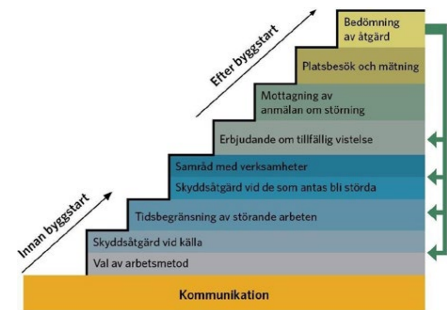
Figur 116. Åtgärdsstrappan som Trafikverket arbetar efter för att minska bullerstörningen i byggskedet.
