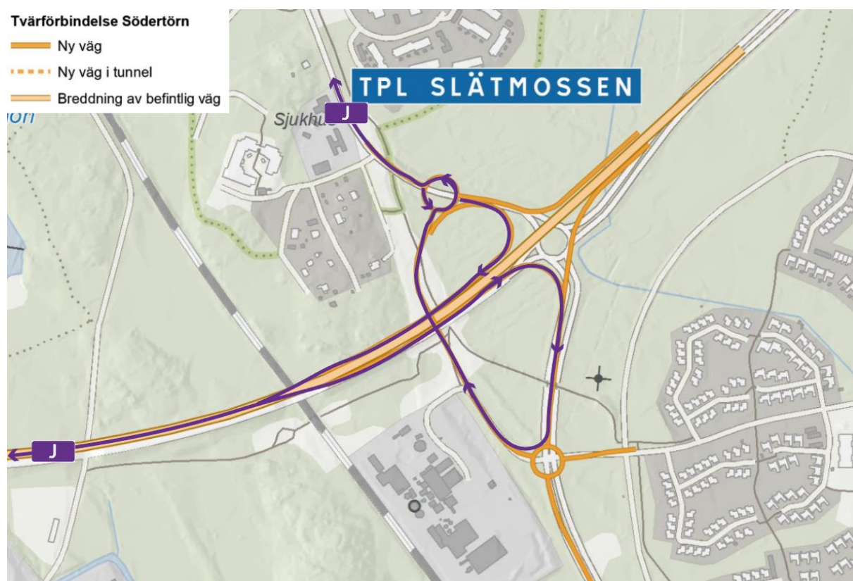
Figur 14. Trafikplats Slätmosse med trafikering av buss.
