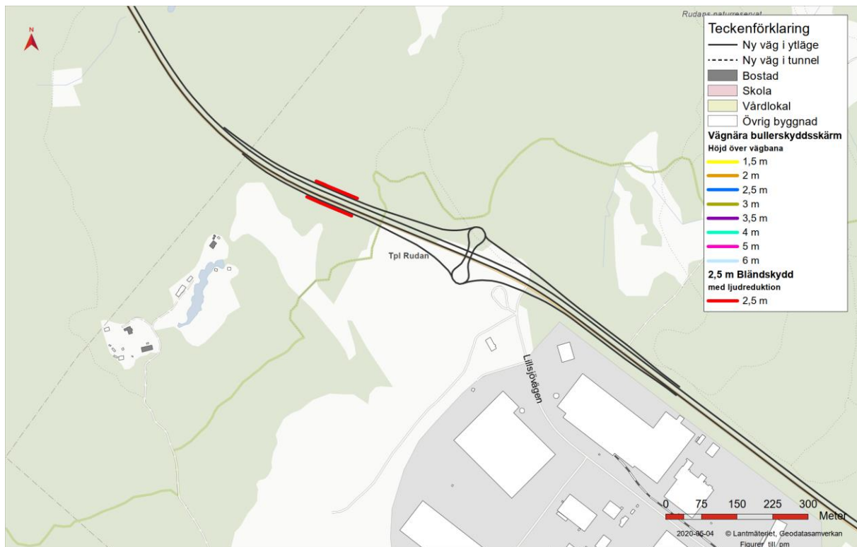
Figur 35. Vägnära skärmar vid Sörmlandsledens passage under Tvärförbindelse Södertörn, delområde 8 Jordbro västra.
