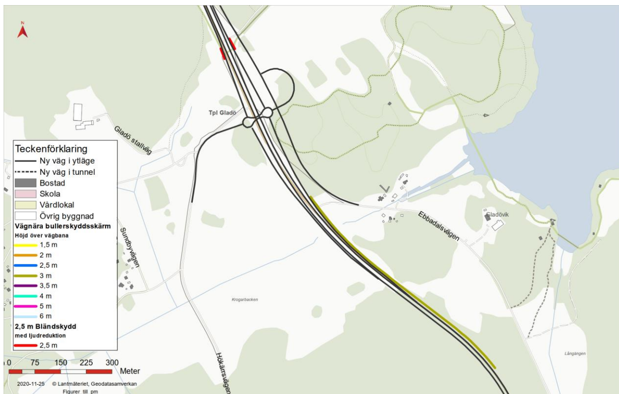
Figur 26. Vägnära bullerskyddsskärmar, norra delen av delområde Gladö. Skärmarna norr om trafikplats Gladö är bländskydd som utförs så att de även har bullerreducerande funktion.
