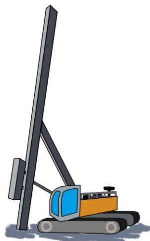
Figur 5 Spontmaskin eller pålkran
