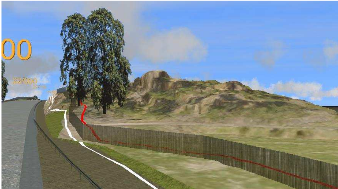
Bild 21. Sidoutformning med viltstängsel och räcke.
