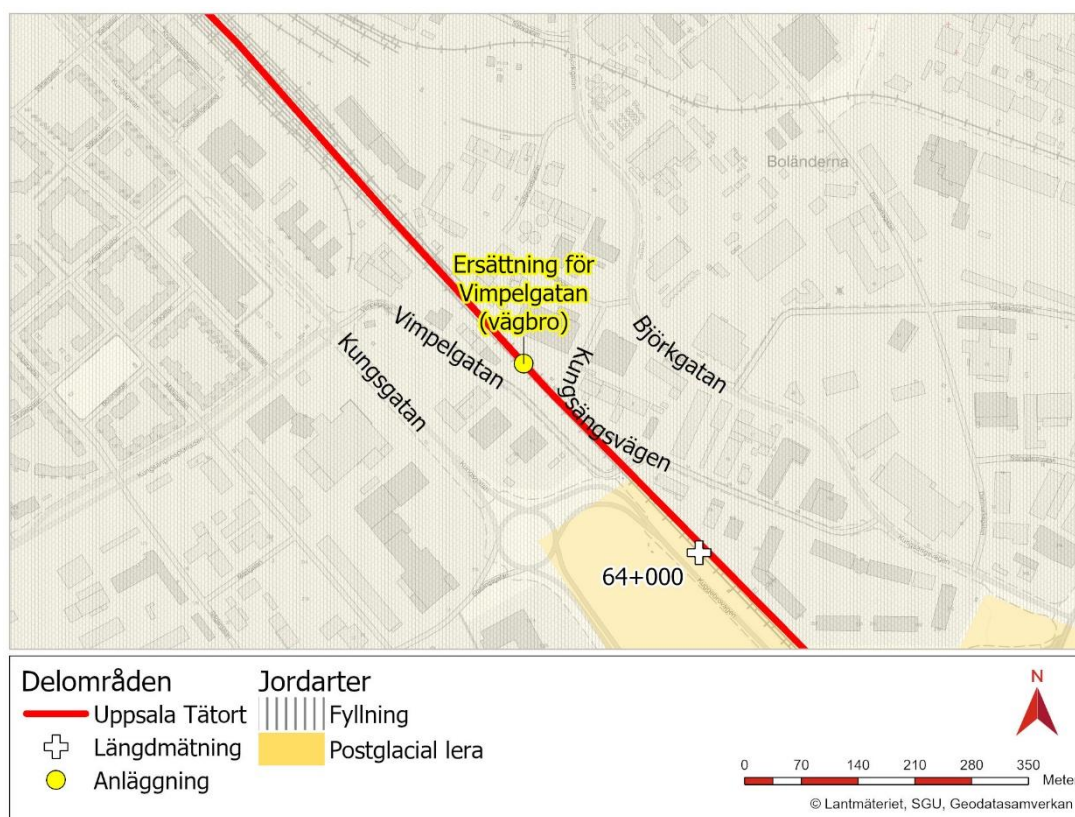
Figur 1. Översiktskarta som visar läget för den nya bron över järnvägen vid Vimpelgatan samt jordarter i markytan enligt SGU:s Jordartskarta (SGU a, 2025).
