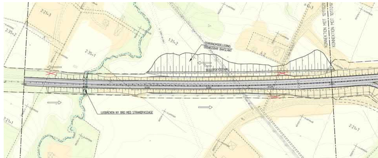
Figur 10. Ny bullerskyddsvall i odlingslandskapet vid cirka km 0/200-0/500 får en flack utformning.
