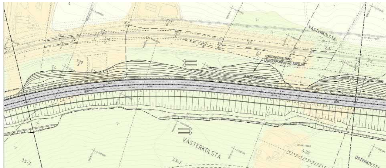
Figur 12. Del av ny bullerskyddsvall mellan cirka km 2/770 -4/000 anpassas till skogslandskapet
