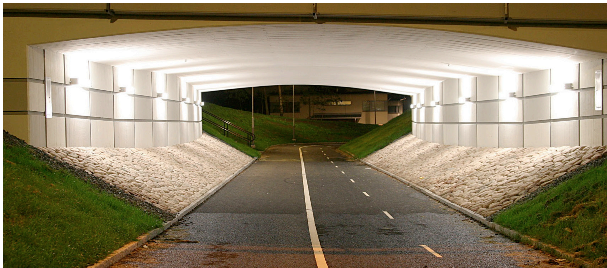
Bild 12. Exempel på hur porten i korsningen vid Nacksta kan utformas för att skapa en ljus och välkomnande entré till Sundsvall. Porten belyses med diskret men ljus belysning. Vålvda innerväggarna gör att porten upplevs större. Stensättningen skapar stadsmässighet. Foto: Fergin
