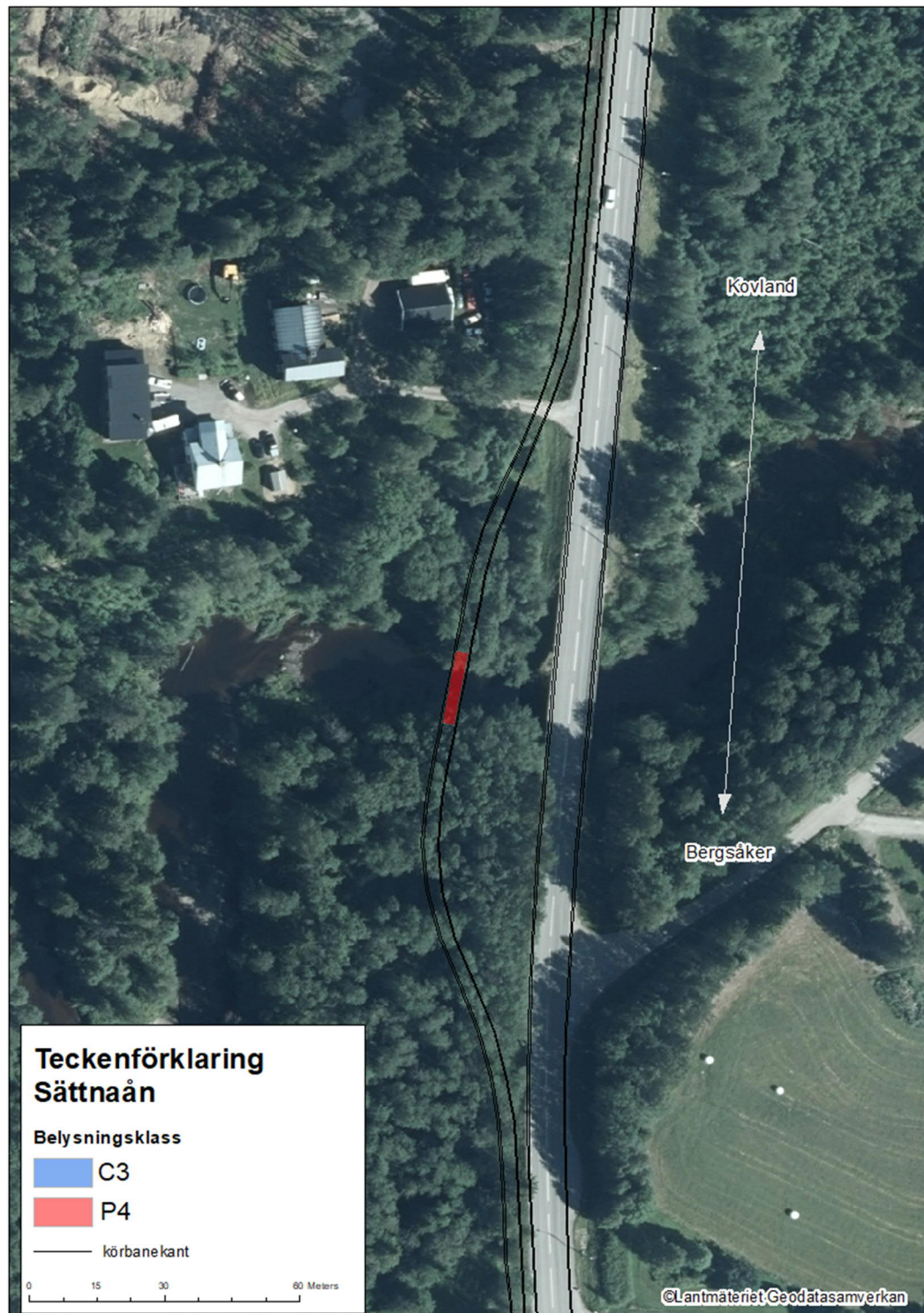
Figur 12. Skiss föreslagen belysningsklass och utbredning i ravin över Sättnaån. Källa: ©Lantmäteriet, Geosamverkan.
