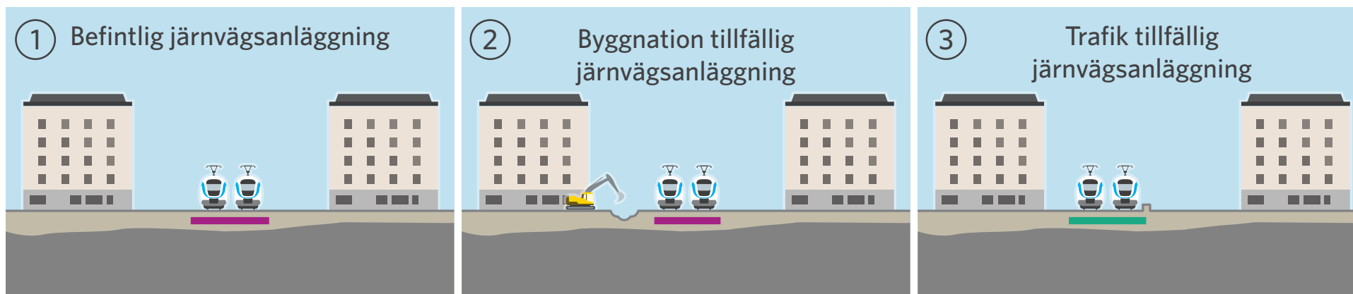
Figur 40. Schematisk illustration av den tillfälliga järnvägsanläggningen.
