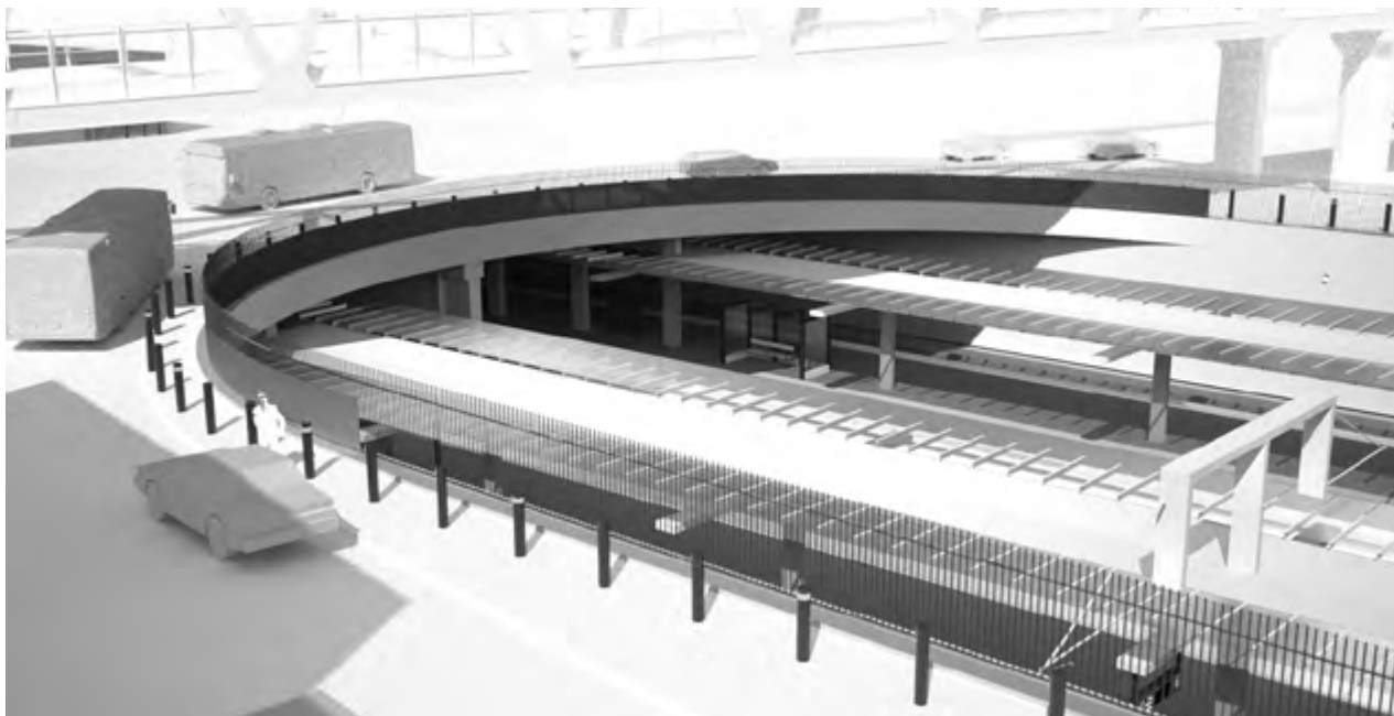
Tråget med pollare som påkörningsskydd
