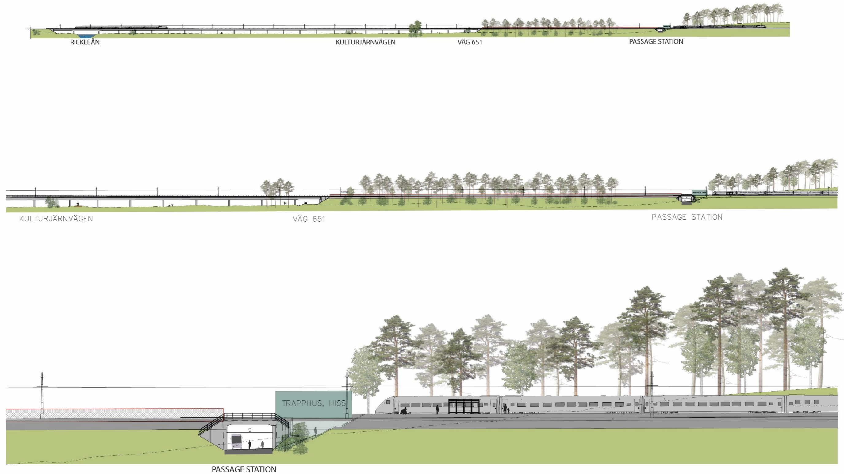
Figur 4.2-12 Järnvägens passage mellan Rickleån och den planerade regionaltågsstationen, cirka km 56+000 till 57+800.
