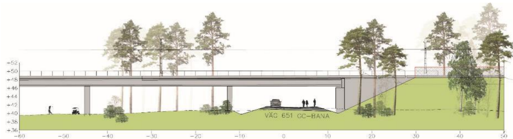
Figur 4.2-10 Järnvägsbro, del av landskapsbron, över väg 651 och gång- och cykelväg, km 56+520.
