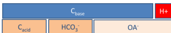
Figur 4. Förenklad laddningsbalans enligt modell från Köhler 2014 där jämviktskoncentrationen av H^+ beräknas enligt en iteration där laddningsbalans av de andra kända parametrarna såsom C_{base} - C_{acid} , HCO_3^- och OA^- utförs. Både OA^- och HCO_3^- beror på pH varför det krävs ett iterativt beräkningssätt. Beräkningsmodellen finns tillgänglig i form av ett Excel-verktyg.
