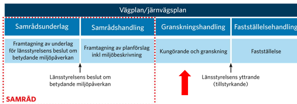
Figur 2. Planläggningsprocessen för projekt som inte antas medföra betydande miljöpåverkan. Röd pil visar var i planläggningsprocessen projektet befinner sig.
