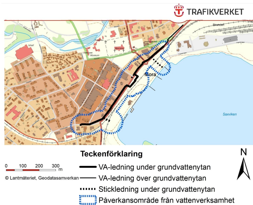
Figur 15. Påverkansområdet vid fullt utbredd grundvattenavsänkning illustreras med blåstreckad linje i kartan. Påverkansområdet är beräknat runt de delar av ledningen som ligger under grundvattenytan.
