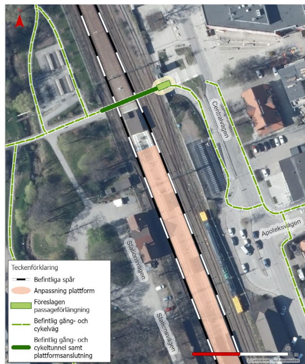
Figur 6. Föreslagen förlängning av gång- och cykeltunnel
