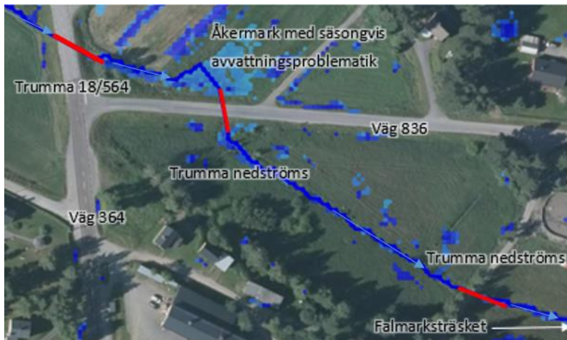
Figur 4. Översikt av problemområdet med modellerad rinnväg samt lågpunkter där vatten kan ansamlas.
