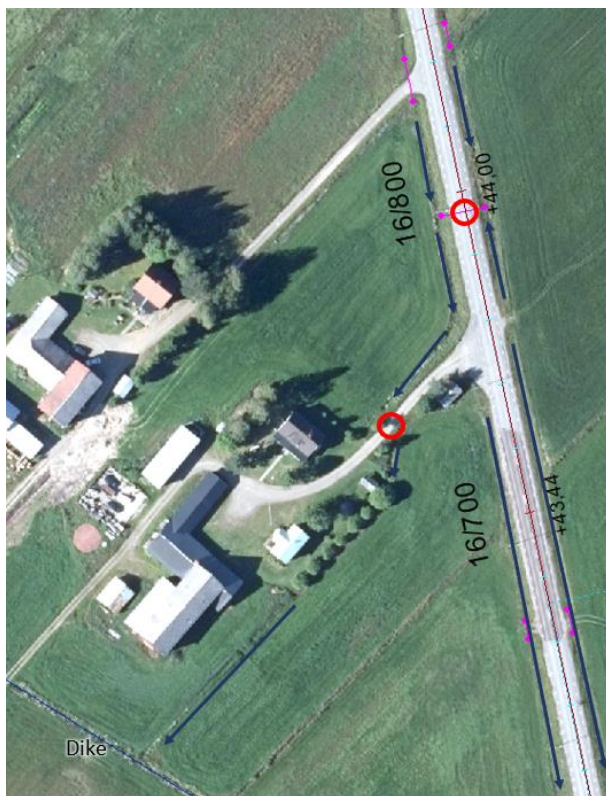
Figur 3. Befintlig avvattningssituation vid km 16/900–16/600. Röd markering visar igensatta trummor. Blå pilar visar schematiskt avrinningen längs med dikena. I neder vänstra hörn ses det större diket som avvattnar åkermarken kring Flaten.
