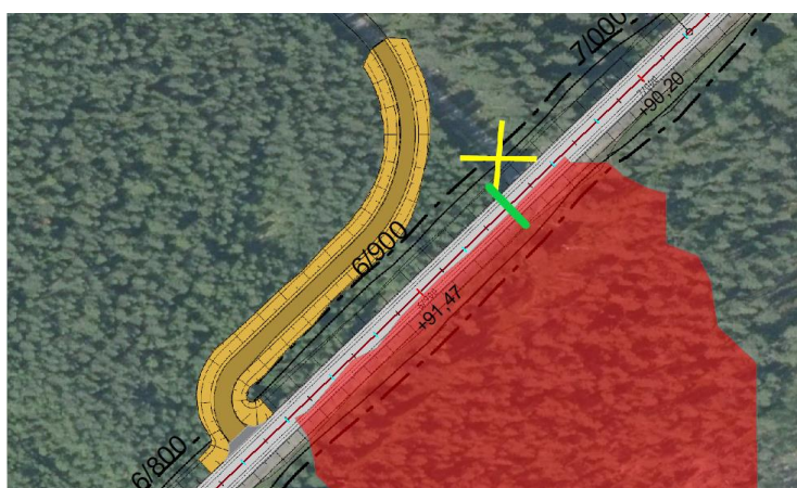
Figur 14. Föreslagen ny infart till Sidtorp samt föreslagen trumma (grönt streck). Rött område visar på troligt avrinningsområde till trumma på ca 1,6 ha om befintlig terräng längs med vägens högra sida inte ändras.
