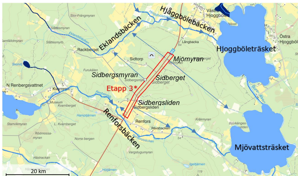
Figur 1. Översikt av ytvattenförekomster i närområdet markerade i blått. Pilar visar schematiskt avrinnningen mot recipient. *Röd markering visar utbredning av etapp 3 där vägen breddas/profiljusteras och avvattningsåtgärder kommer att utföras.
