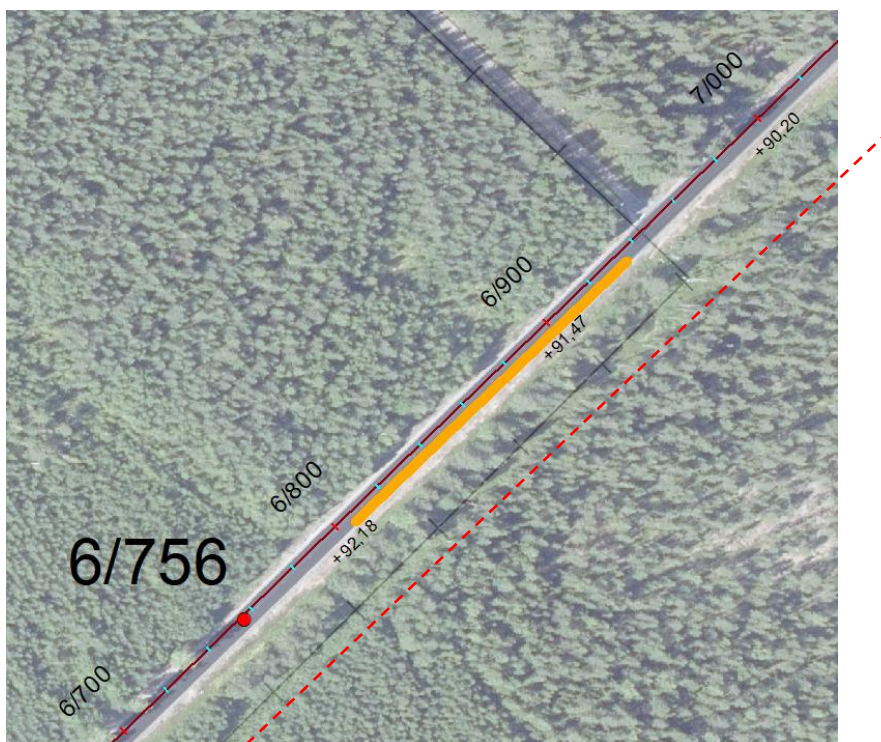
Figur 7. Översikt av problemområde enligt skadeinventering (orange) längs med höger sida av vägen. Röd cirkel visar befintlig vägtrumma. Röd streckad linje visar profil längs med höger sida av vägen, se Figur 8.
