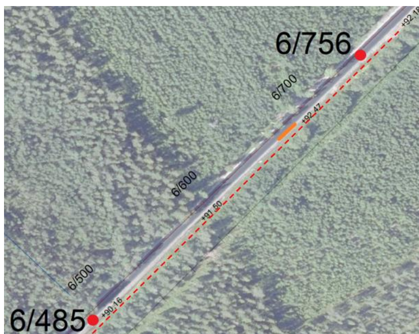
Figur 10. Översikt av problemområde enligt skadeinventering (orange) längs med högra diket. Röd markering visar befintliga vägtrummor. Röd streckad linje visar profil i terräng längs med höger sida av vägen, se Figur 11.
