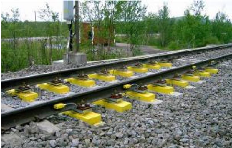
Figur 5: Hjulskadedetektor av typen SCHENCK
