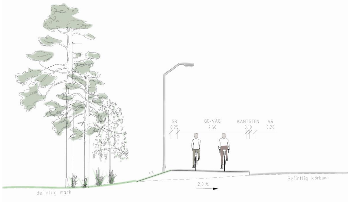
Figur 19. Illustration av möjlig utformning av GC-vägen med kantsten i trängre partier där inte skiljeremsa tillåts
