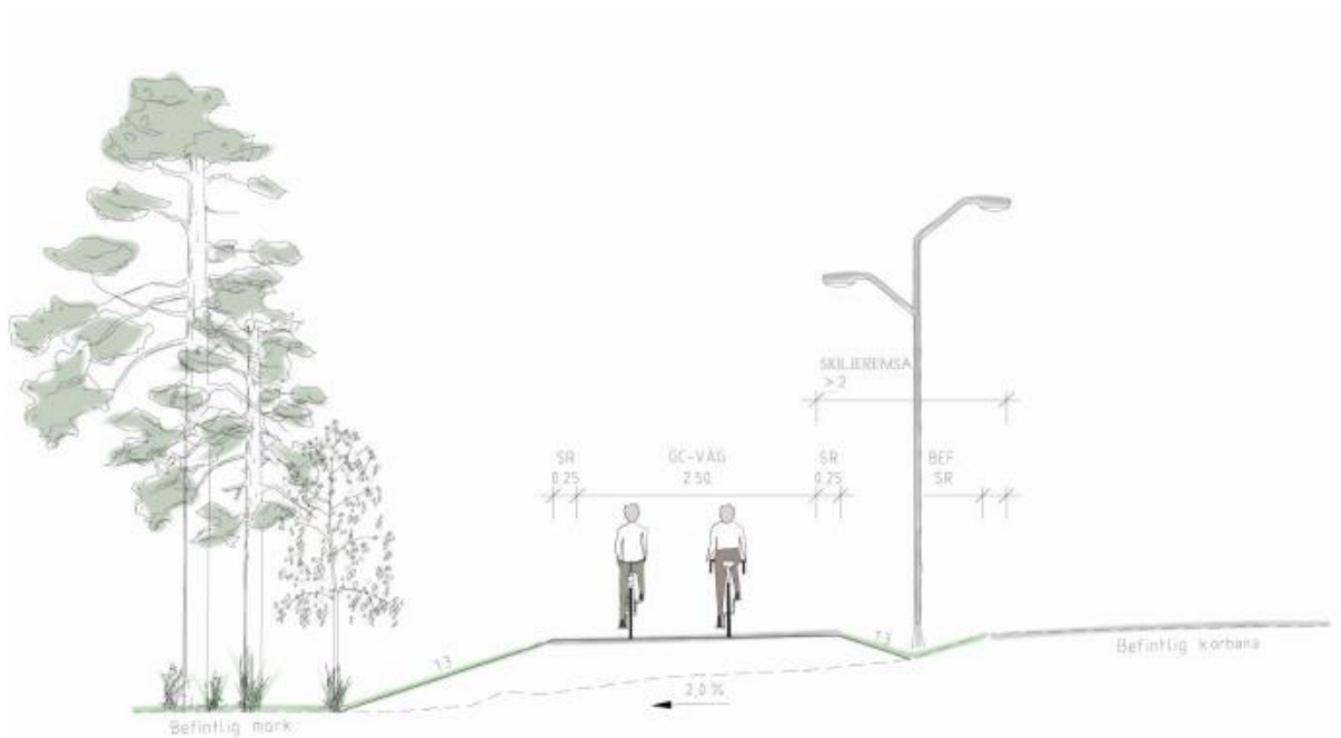
Figur 18. Illustration av möjlig utformning av GC-vägen med en skiljeremsa mot väg 83.
