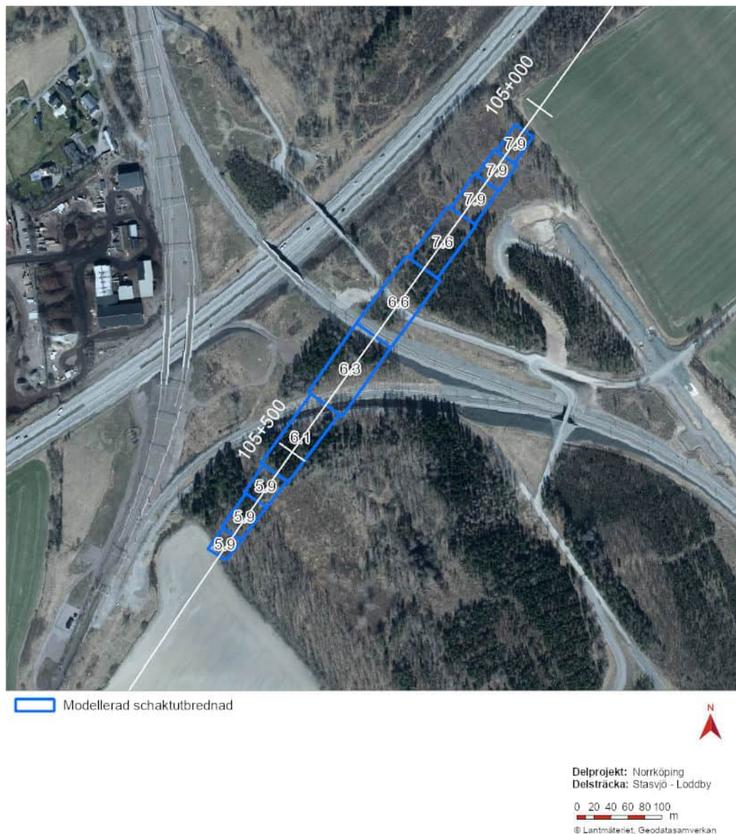
Figur 61. Modellerad schaktubrednad, med sektioner och dräneringsnivåer.
