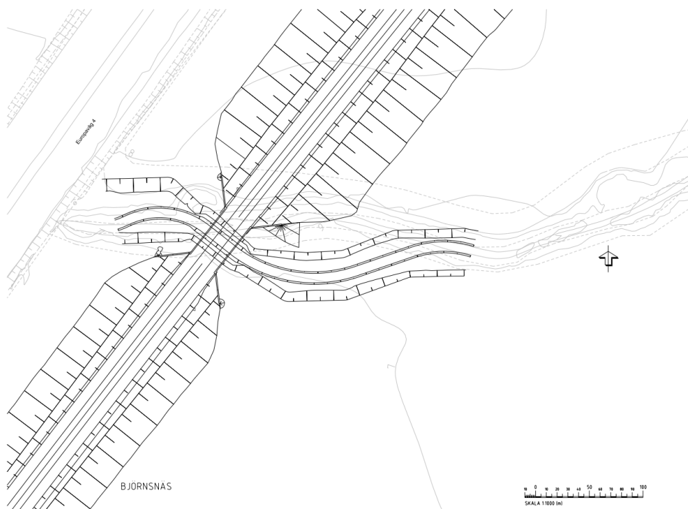
Figur 1. Reviderad skiss över omledningen av Torshagsån
