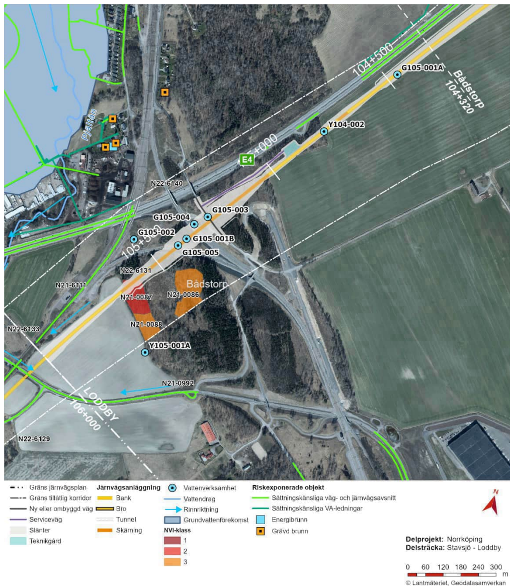
Figur 82. Riskexponerade objekt inom sträcka Bådstorp - Loddby. Av ortofotot kan utläsas att järnvägen på sträckan passerar genom ett område med jordbruksmark och ett litet skogsområde.
