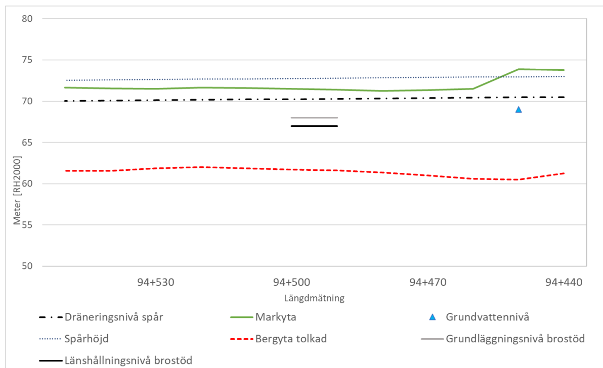
Figur 20. Profil brostöd vid km 94+440 – km 94+530.
