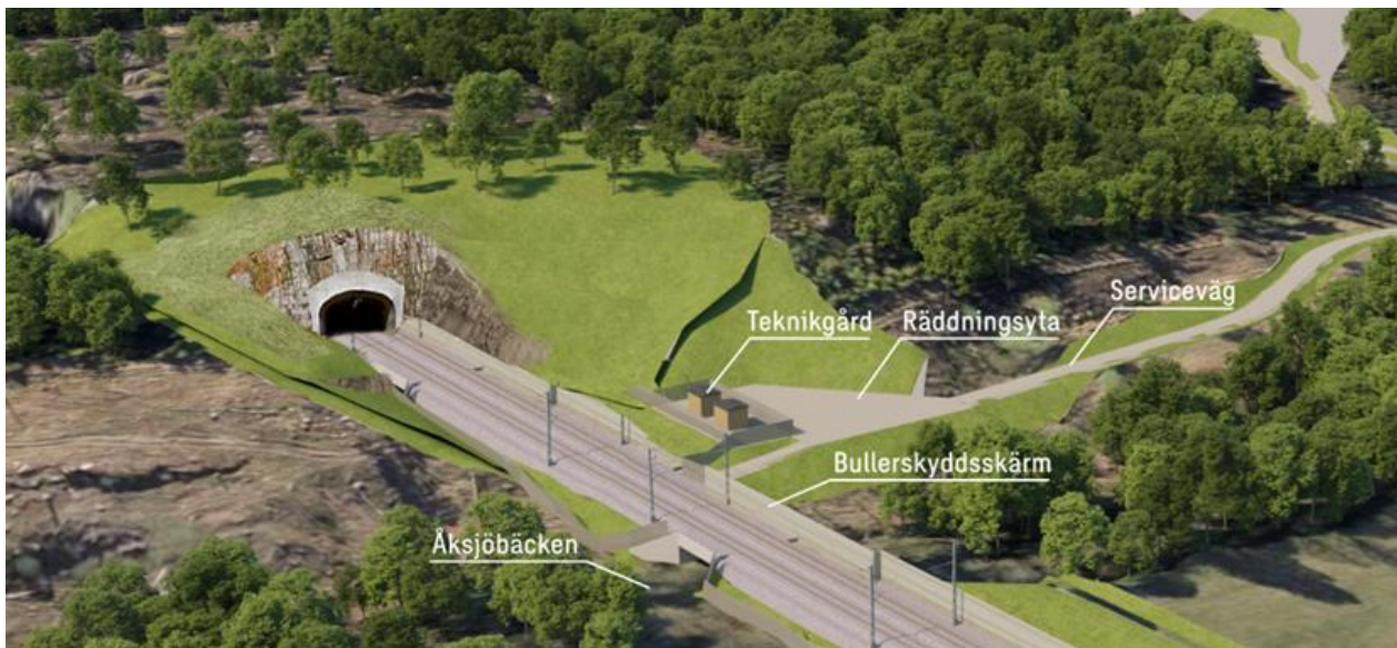
Figur 7.6. Illustration av möjlig utformning av norra tunnelmynningen och järnvägsbro över vattendraget Åksjöbäcken. Illustrationen avser Ostlänkens färdiga utformning, varför tillfälliga ramper och andra tillfälliga ytor inte finns med på illustrationen.
