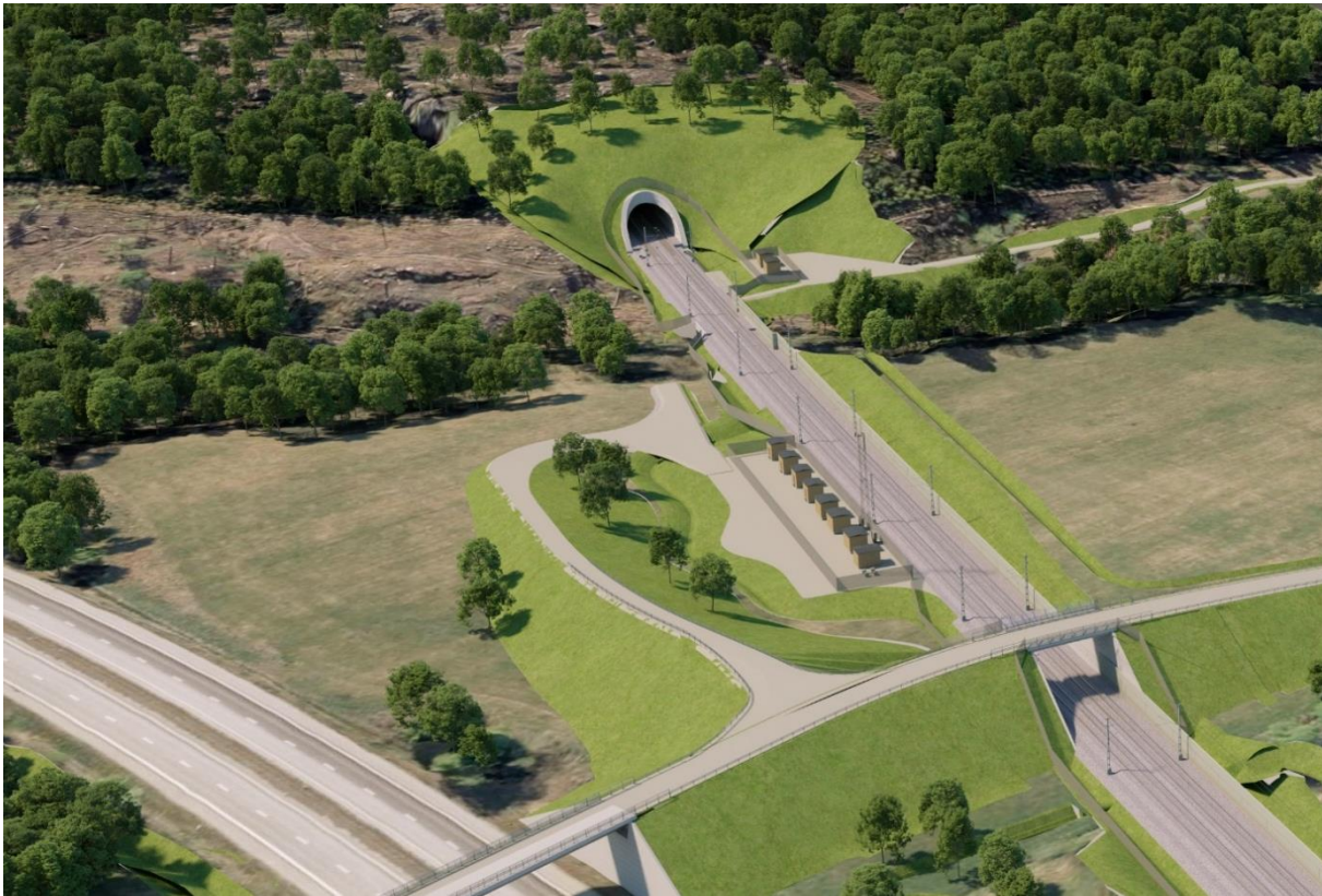
Figur 6. Illustration av möjlig utformning av norra tunnelmynningen och järnvägsbro över vattendraget Åksjöbäcken. I förgrunden ny bro över E4 och Ostlänken inom delområde Stavsjö-Böksjö. Illustrationen avser Ostlänkens färdiga utformning, varför tillfälliga ramper och andra tillfälliga ytor inte finns med på illustrationen.
