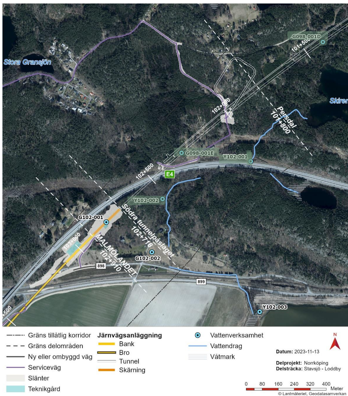
Figur 24. Vattenverksamheter vid södra tunnelpåslaget
