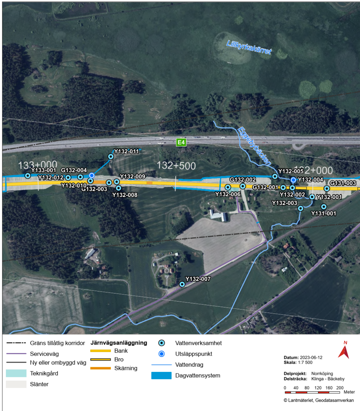
Figur 25. Bortledning av dränvatten tillsammans med dagvatten för G132-003.
