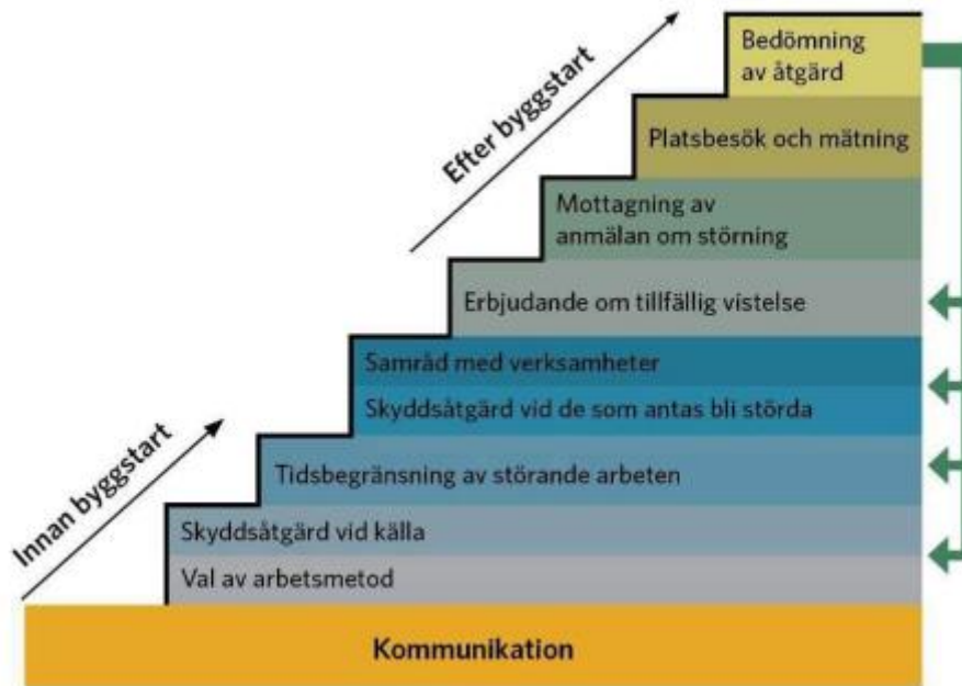
Figur 2. Åtgärdstrappan som Trafikverket arbetar efter för att minska bullerstörningen i byggskedet.
