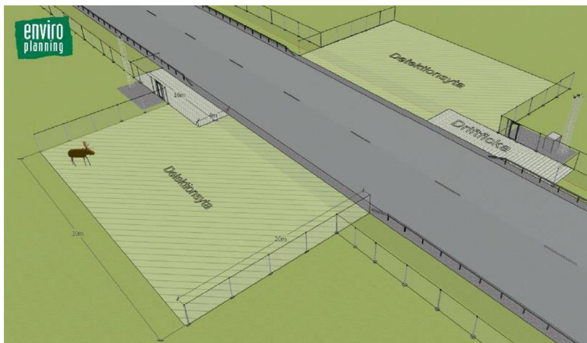
Figur 42. Illustration av faunapassage i plan som fungerar som ett övergångsställe för vilt och som kan försees med ett system för detektering och varning av vilt. Källa: Pilotprojekt vilt.
