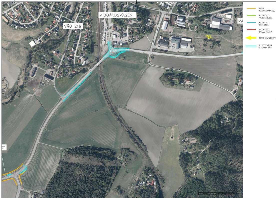
Figur 37. Illustrationskarta över det valda utformningsalternativet vid korsningspunkten mellan väg 218 och väg 219 (Stationsvägen).
