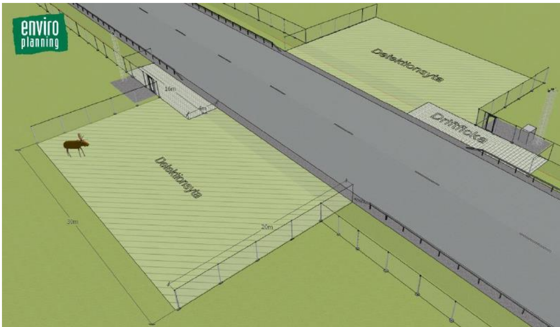
Figur 5. Illustration av faunapassage i plan som fungerar som ett övergångsställe för vilt och som kan förses med ett system för detektering och varning av vilt. Källa: Pilotprojekt vilt 3 .
