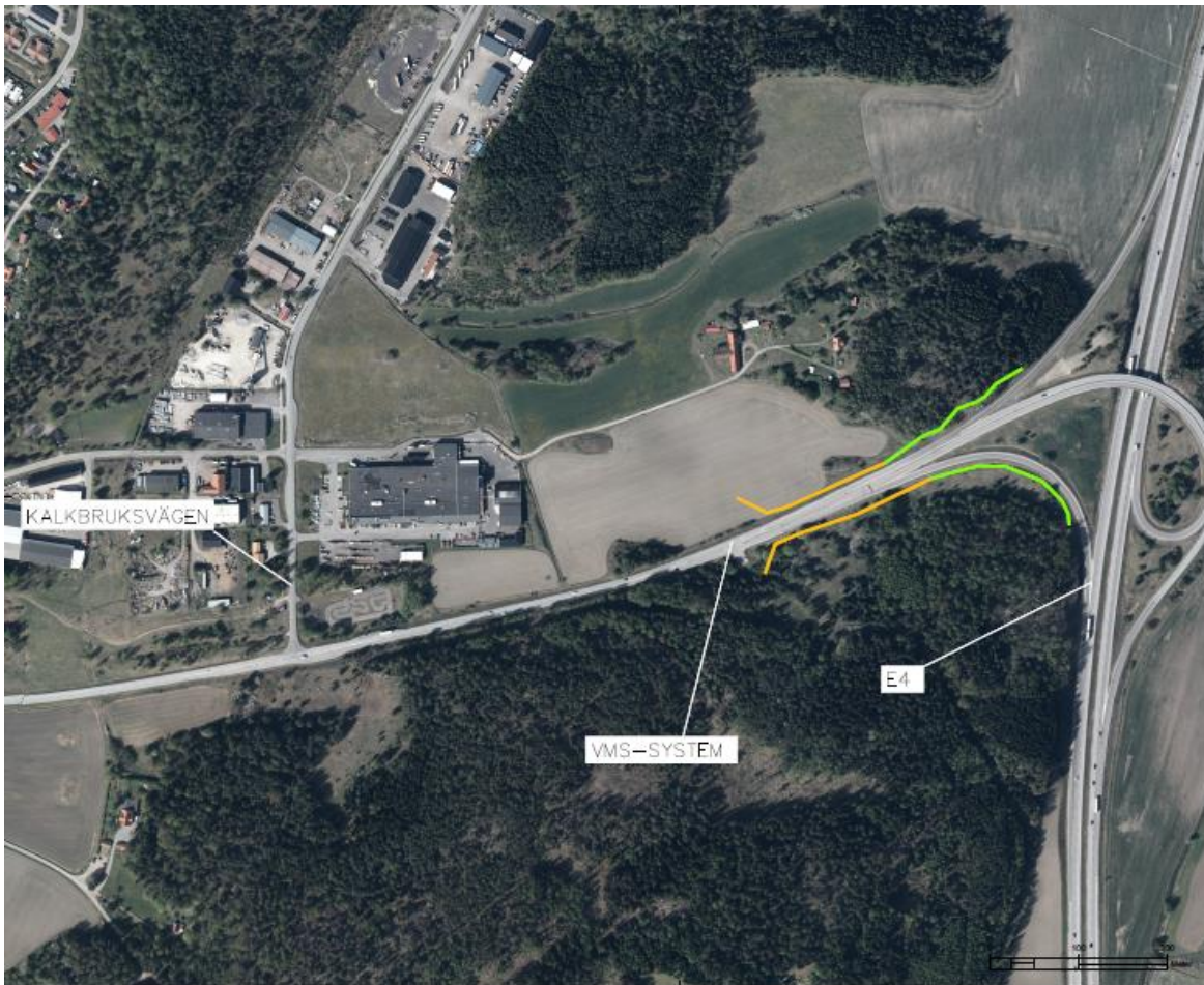
Figur 22. Visar alternativ lösning med aktivt viltvarningssystem där stängsel upphör nedanför ramperna från E4.
