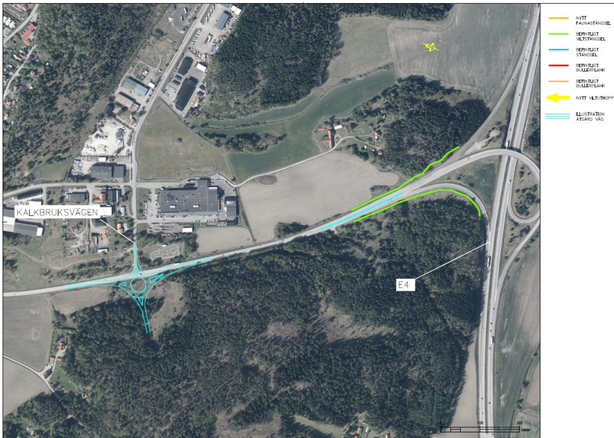
Figur 20 visar hur befintligt viltstängsel i grön färg förlängs med viltstängsel i orange färg i syfte att minska olycksfrekvensen.
