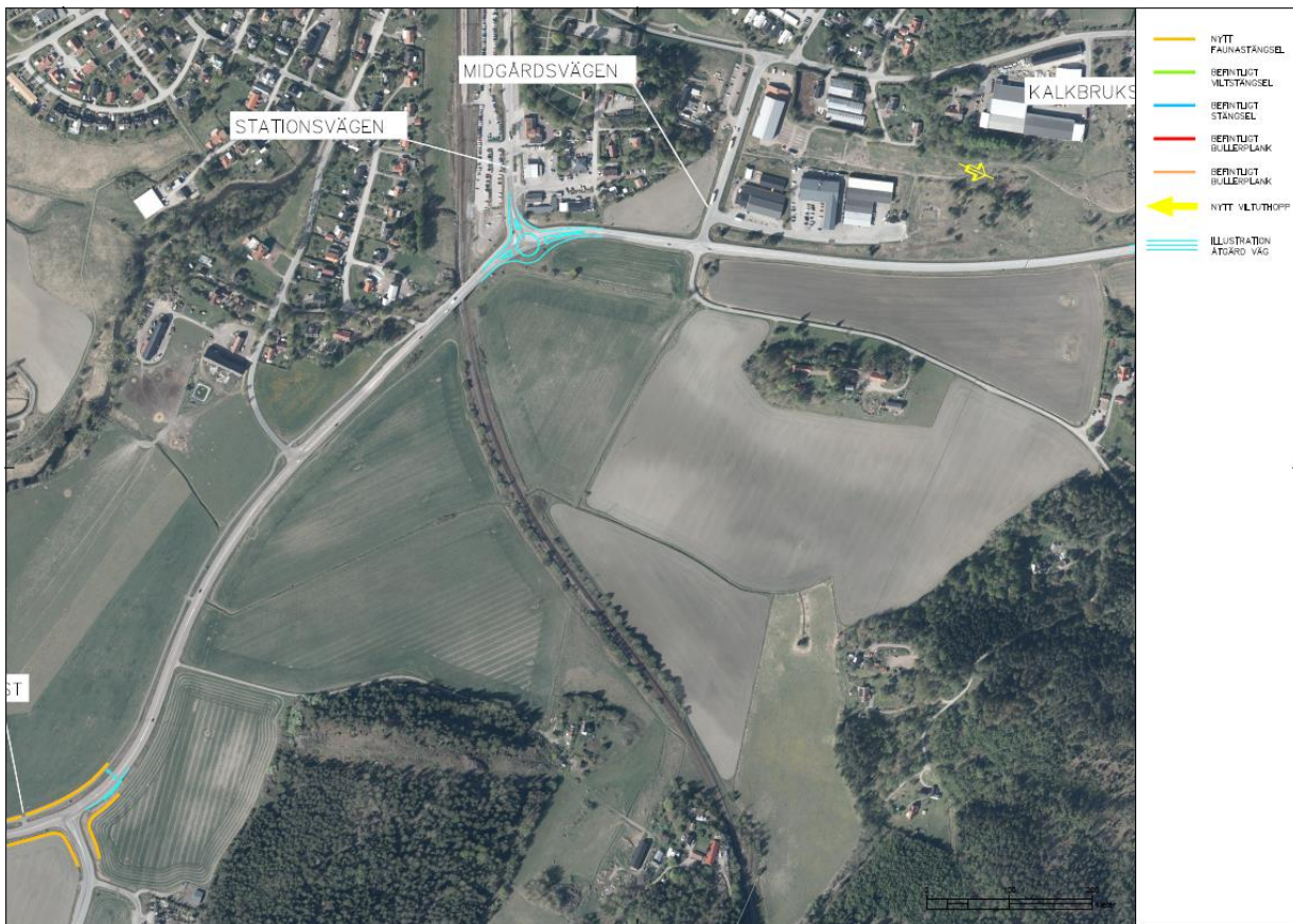
Figur 19. Visar stängselavslut mot väg 800, vilket medför risk att viltolyckorna ökar på väg 800.
