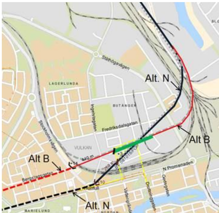
Figur 2 Bergslagsalternativet (Alt B) och Norrstullalternativet (Alt N) med upphöjd plattform markerad med grönt samt markerade tunnelpåslag.
