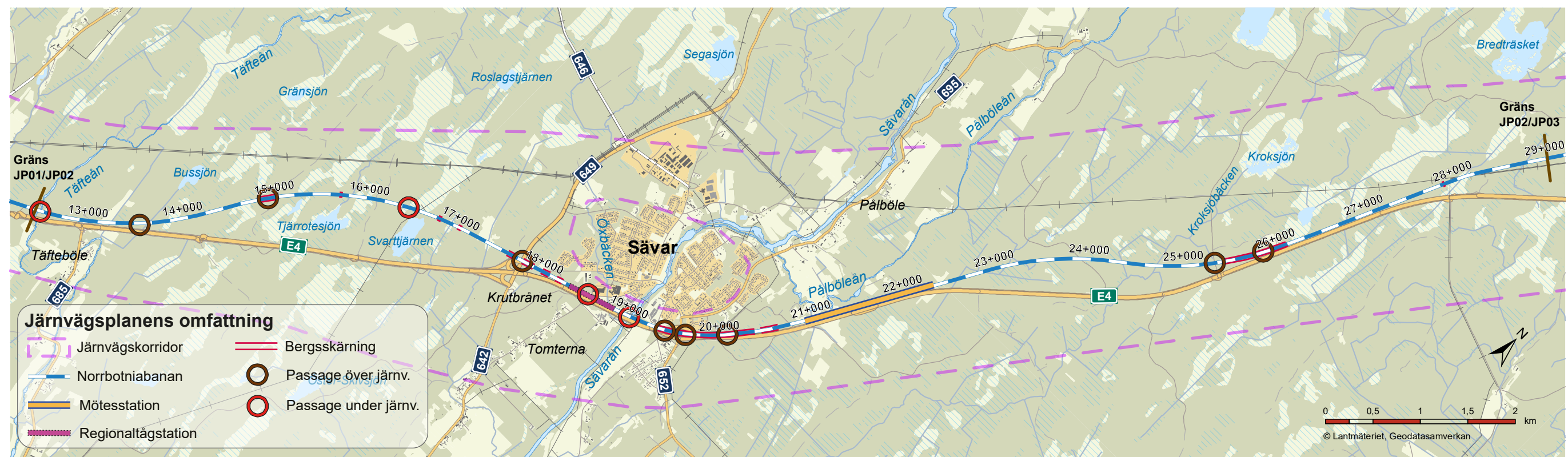
Figur 5.1-1 Järnvägsplanens omfattning. Översiktskarta över delsträckan Däva-Gryssjön som visar var järnvägen ligger på bank, bro respektive i skärning.
