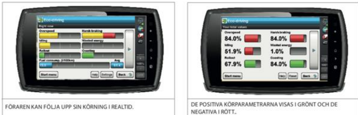
Bild 13 Vehcos tjänst för sparsam körning ger direkt återkoppling till föraren samt sparar data för efteranalys.
