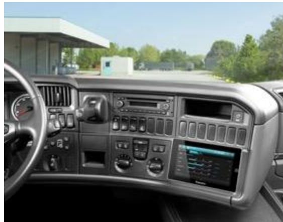
Bild 11 Transics system TX-SKY ger föraren överträdelsevarningar via en pekskärm integrerad i fordonet.
