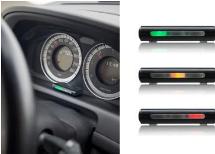
Bild 17 Köra Säkert ger återkoppling till föraren via en ljusindikator.
