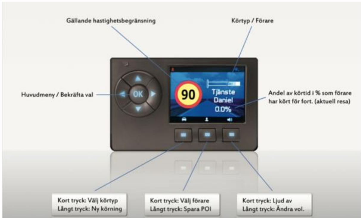
Bild 12 Illustration av Sepabs ExyPro-skärm där föraren får hastighetsinformation och varningar.
