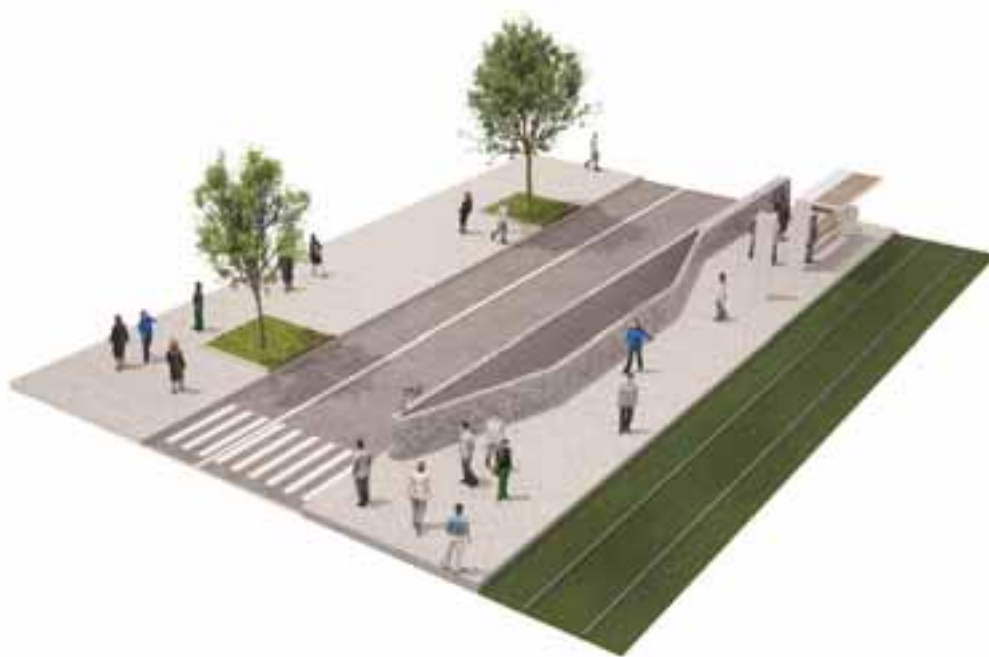
FIGUR 5.40. Illustrationsexempel som visar överbyggnad för tryckutjämningschakt. Den föreslås här anpassad till gatans refug och bidrar till trafiksituationen i form av en stödmur.
