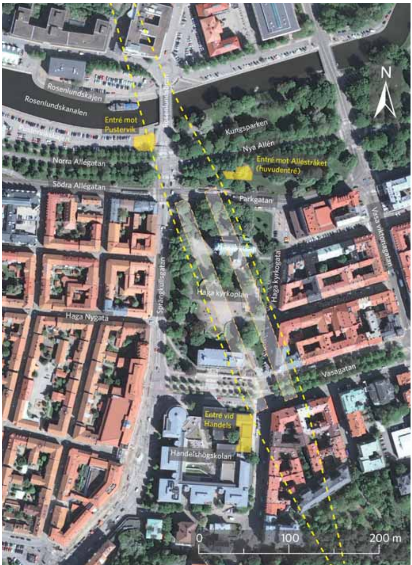
FIGUR 6.2. Flygfoto som visar Station Haga med omgivning. Tunnelsträckning visad med gul streckad linje. Tågplattformar visade svagt vita med orange streckad linje.
