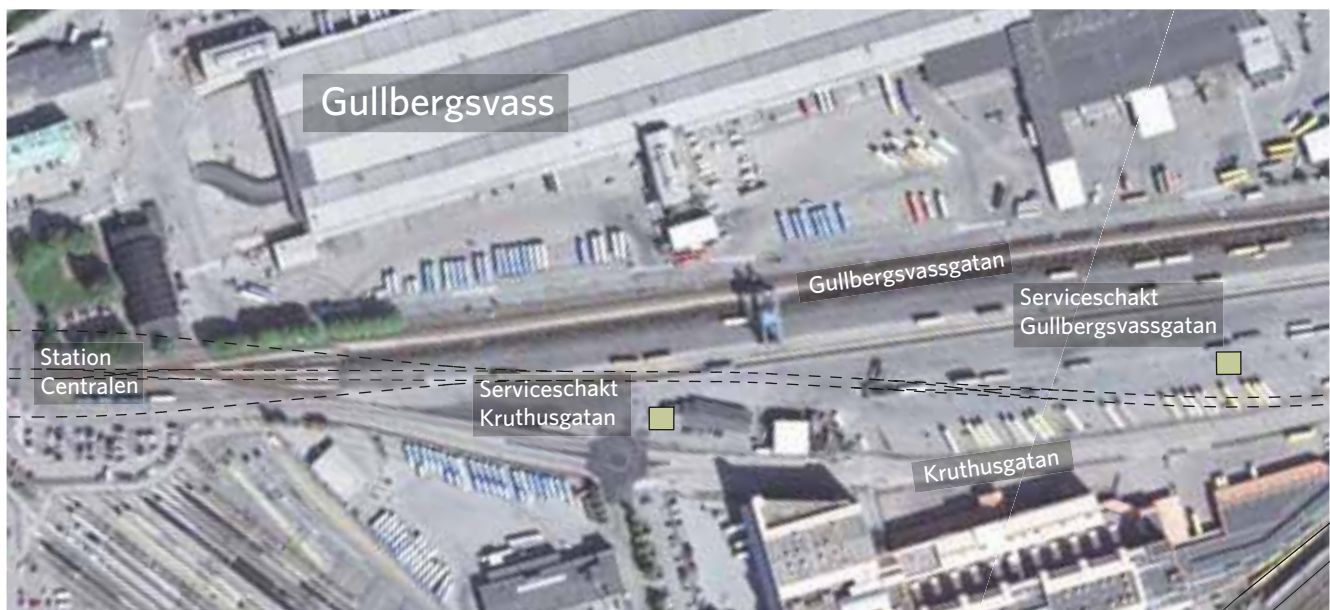
FIGUR 4.40. Plan över serviceschakt vid Kruthusgatan och Gullbergsvassgatan med Gullbergets västra sluttning till höger i bilden. Göteborgs Stads vision är att skapa ett öppet parkstråk mellan Station Centralen och Gullberget. Serviceschakten hamnar i
