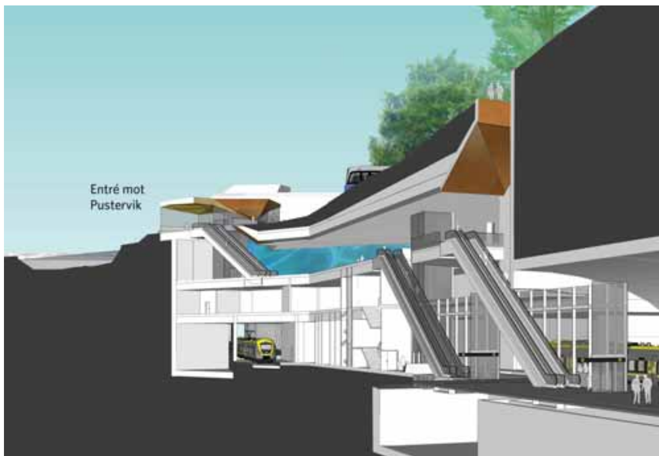
FIGUR 6.14. Sprängskiss genom stationstunneln och den norra uppgången med entrén mot Pustervik längst bort. Metallpaneler i dagsljusintag o
