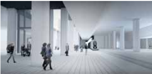
FIGUR 7.30. Vy av plattform med dubbla pelarrader. Sikten mot uppgångar försvåras på grund av de kraftiga pelarna. Svårigheter att orientera sig samt att ej kunna se vilka som uppehåller sig på plattformen kan skapa otrygghet.
