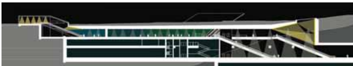
FIGUR 6.13. Skiss som visar föreslagna belysningsprinciper för den norra uppgången med principer för konstljusbelysning av dagsljusintag när dagsljuset ej finns att tillgå (gul kulör i illustrationen).
