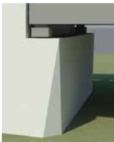
FIGUR 4.10. Princip för landfästen. Hörn på volymer med prismatiskt fasning.
