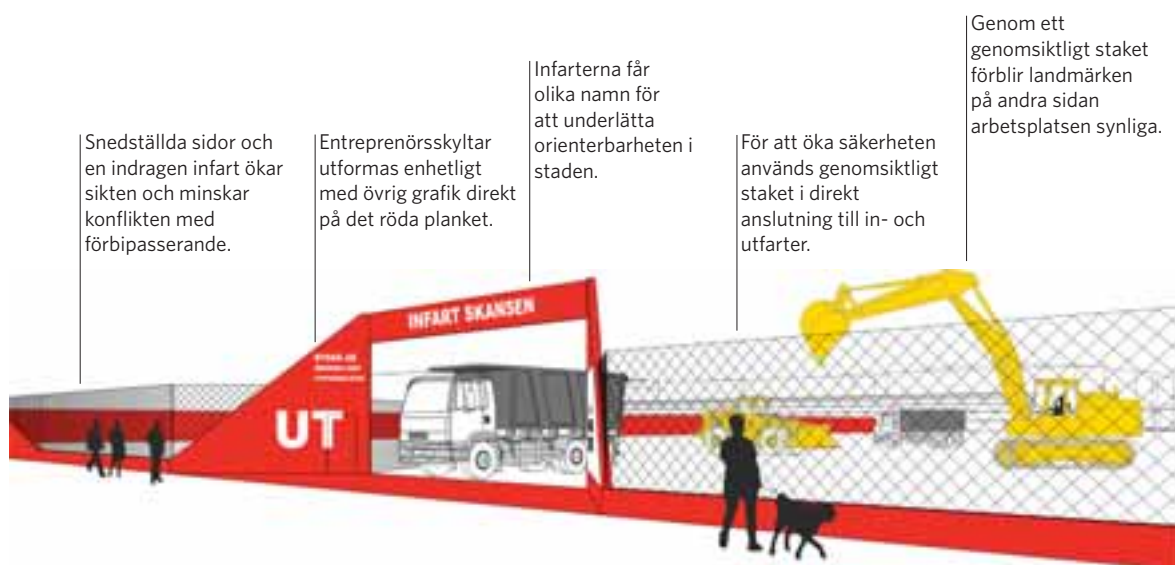
FIGUR 8.13. Illustrationsexempel. Utfarter markeras tydligt för att uppmärksamma risken för passerande fordon. Avskärmingens grafiska profil och pedagogiska syfte bibehålls genom att låta det röda bandet rama in utfarten.
