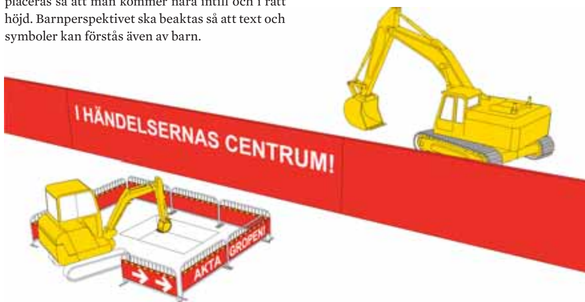
FIGUR 8.23. Illustrationsexempel. Låga avskärmade staket, som används för enkla avspärningar, kan också täckas med banderoller för att skapa enhetlighet och underlätta orientering i byggskedet.
