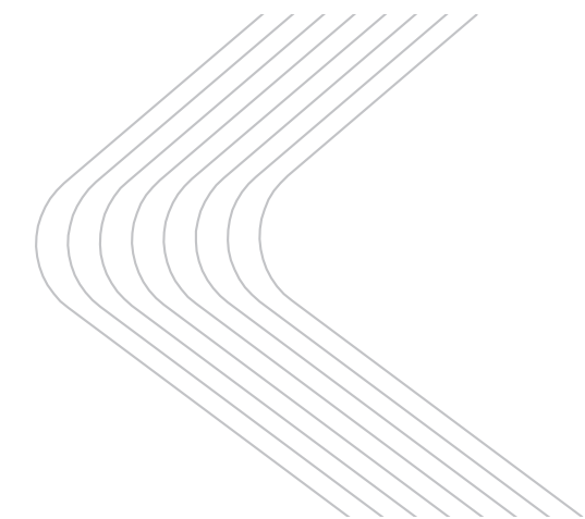
Figur 6. Princip i plan över utformning där två slänter möts. Mötet ska utformas rundat i plan. Linjerna representerar höjdkurvor.
