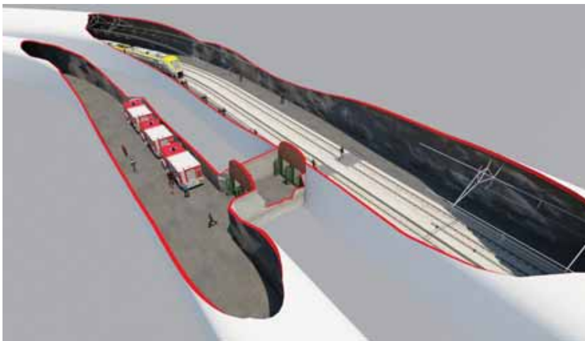
FIGUR 18.14. Spårtunnel och utrymningsväg till servicetunnel.
