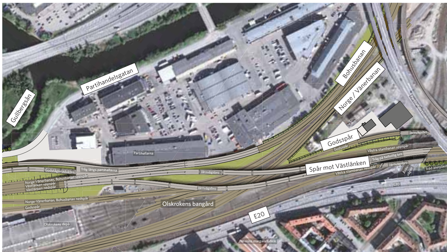
FIGUR 4.6. Utformning av Olskroken planskildhet i Olskroken.
