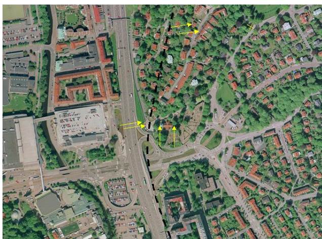
Figur 3.10 Den streckade svarta linjen indikerar Gårdatunnelns läge kring Lisebergsmotet. Pilarna till vänster i bild indikerar mätningar gjorda under mark vid Liseberg station. Till höger om dessa visar två pilar mätpunkter vid Örgryte gamla kyrkas västliga och östliga sida. Något längre norrut valde vi två mätpunkter på Överåsgatan (fastigheterna 70:5 och 71:4). Ett kryss uppe till höger i bild indikerar en mätpunkt där det uppmättes oväntat höga magnetfältsnivåer vid frekvensen 16 2/3 Hz. Mätpunkten ligger på 200 meters avstånd från närmaste järnvägs-spår.
