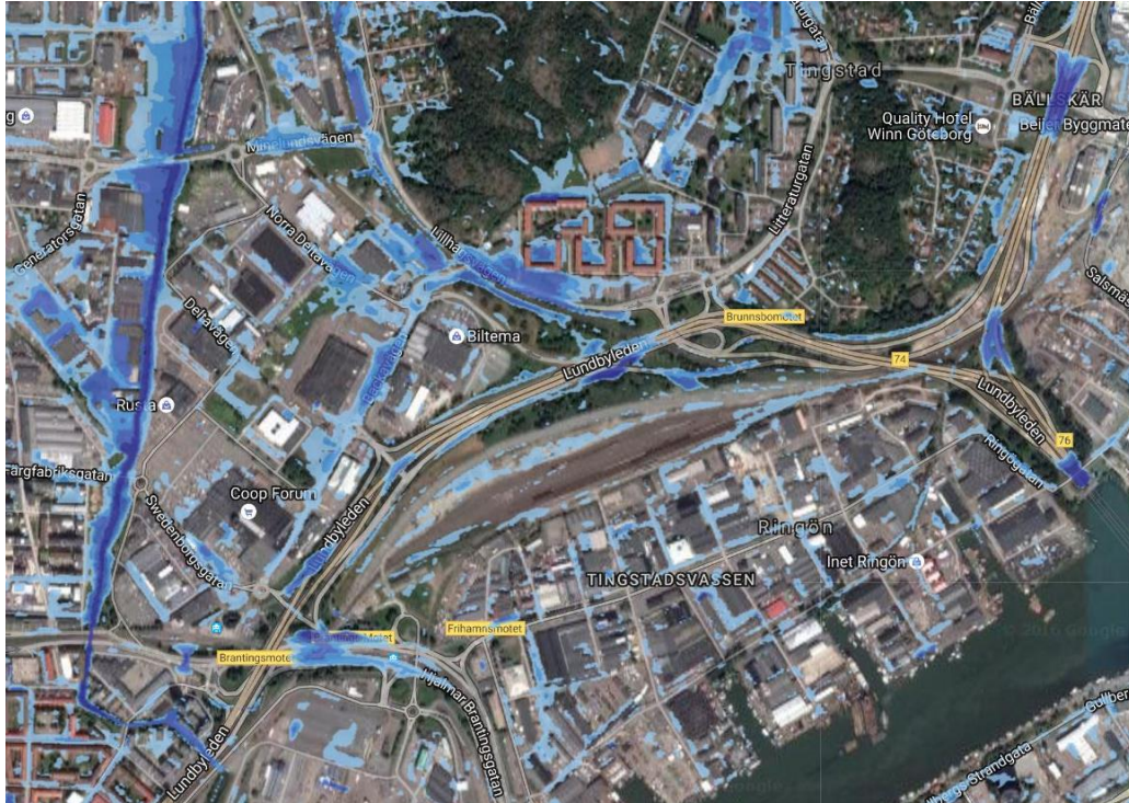
Figur 17 Översvämningssituation vid ett klimatanpassat 100-årsregn. Källa: Vatten i staden.
