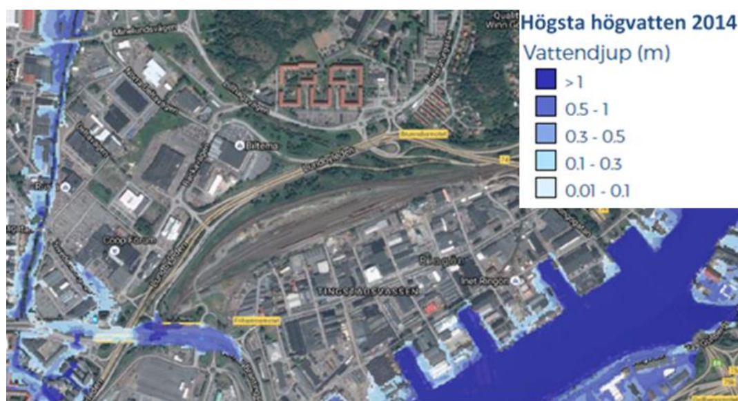
Figur 18 Översvämningssimulering gjord 2014 för en havsnivåpeak med 200 års återkomsttid i Göta älv (Källa: Vatten i staden).
