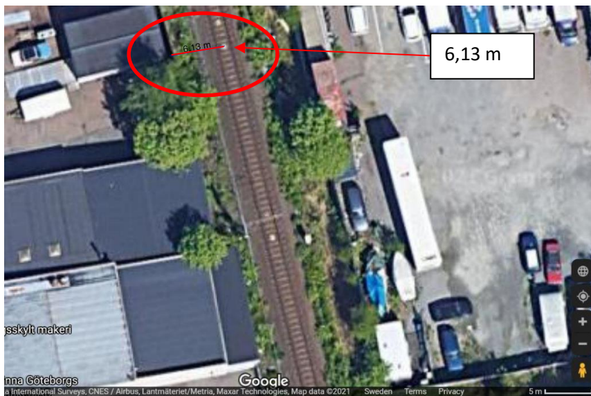
Figur 3 Avståndsmätning till spårmitt för intilliggande förvaringsbyggnad.
