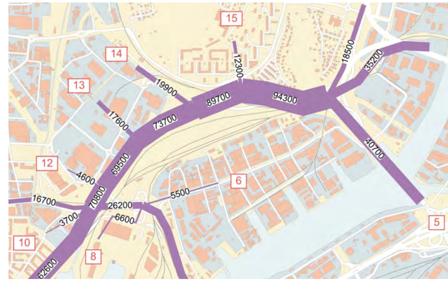
Figur 3.10 Trafikflöden. Vägverkets prognos 2020 samt volymhandel Backaplan (alstringsnivå medel) Fordon per medelvardagsdygn (f/mvd).
