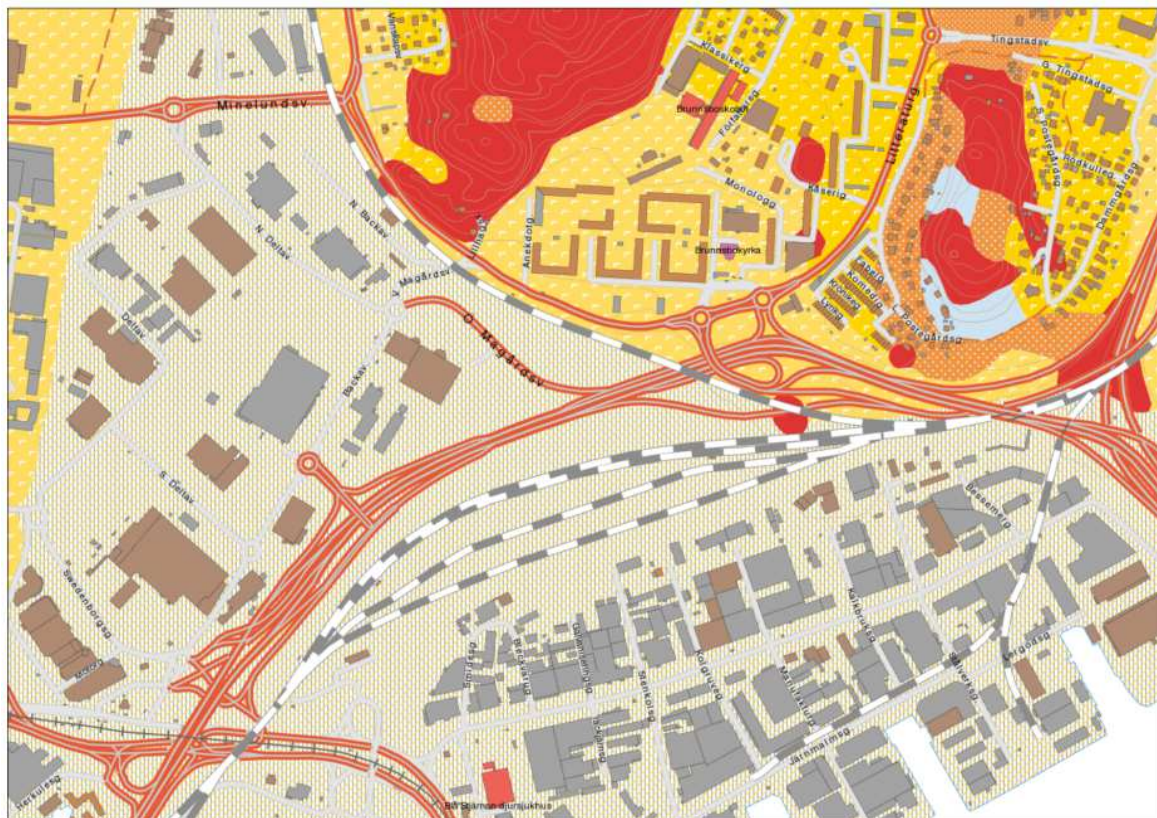
Figur 17 Kartan visar jordarter i markytan där grått är fyllnadsmassor, rött är berg, gult är lera, orange är sand eller grus och ljusblått är morän.
