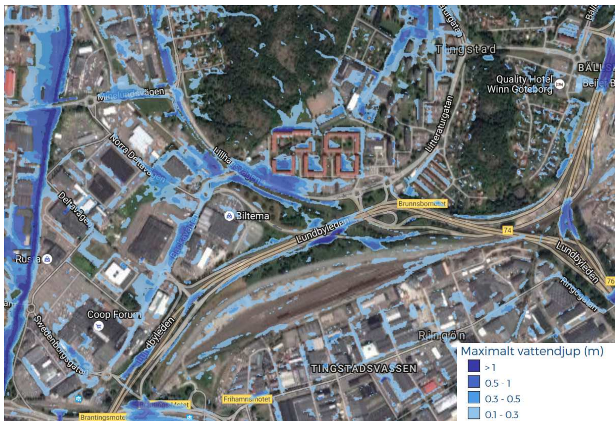
Figur 33 Beräknad översvämningssituation vid ett 100-årsregn med tre timmars varaktighet inklusive en trettio minuters intensiv regntopp.
