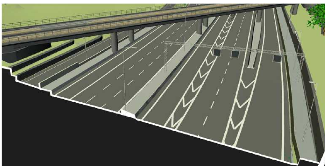
Figur 31 Mittbarriär och stödmurar med terrasser under Bohusbanan.
