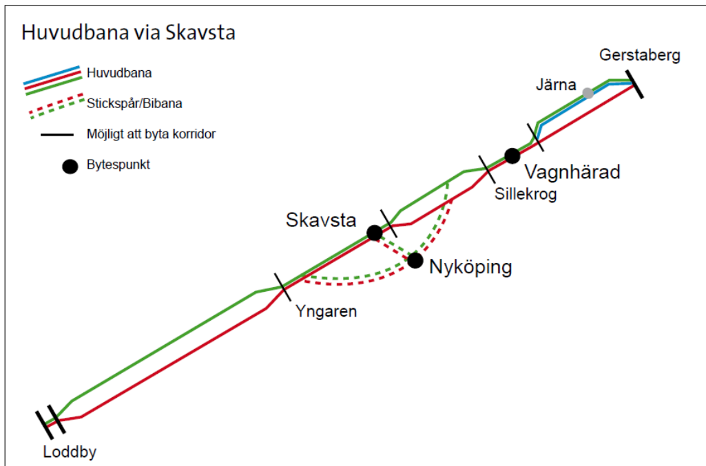
Figur 4. Systemskiss över spårssystem med huvudbana via Skavsta och stickspår (tågen måste vända). Figur hämtad från MKB till järnvägsutredning 2010 (Trafikverket, 2009).
