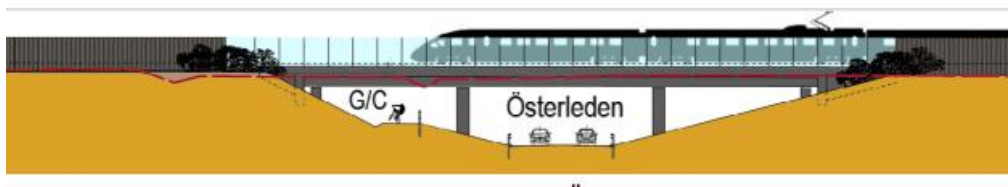
Figur 4-13. Vy mot öster. Längdsektion på trefacksbro där Österleden går under järnvägen. Gång- och cykelvägen förläggs norr om Österleden.
