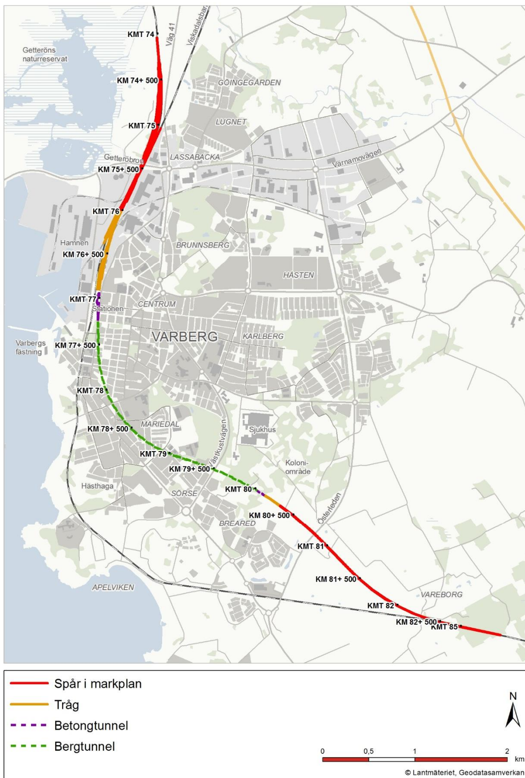
Figur 3-2. Översiktsbild över planerad anläggning.
