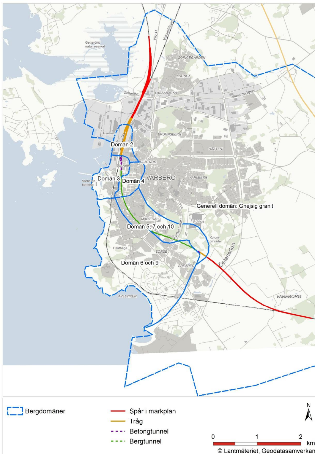
Figur 6-2. Uppdelning av berggrunden i så kallade bergdomäner, det vill säga områden med olika hydrauliska egenskaper.
