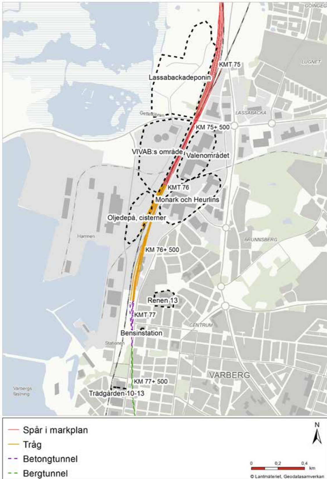
Figur 5.3 Översikt förorenade eller potentiellt förorenade områden. Utöver de områden som är markerade utgör också den befintliga järnvägsanläggningen, som syns väster om planerad anläggning, ett potentiellt förorenat område.
