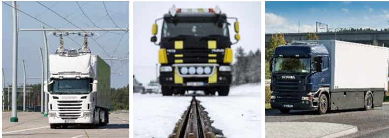
Figur 2: Exempelbilder av de tre överföringsteknikerna, från vänster: Överföring via luftledning [17], överföring via spår i vägen [12], överföring via elektromagnetiska fält [18]
